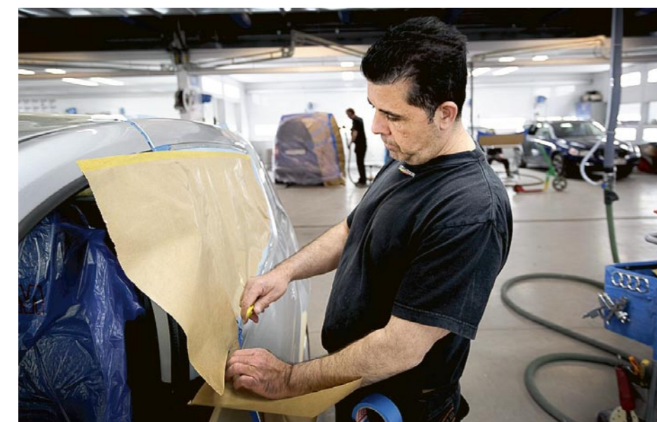
Omlackering. Amer El-Habet är i full färd med att omlackera en krockad bil.
